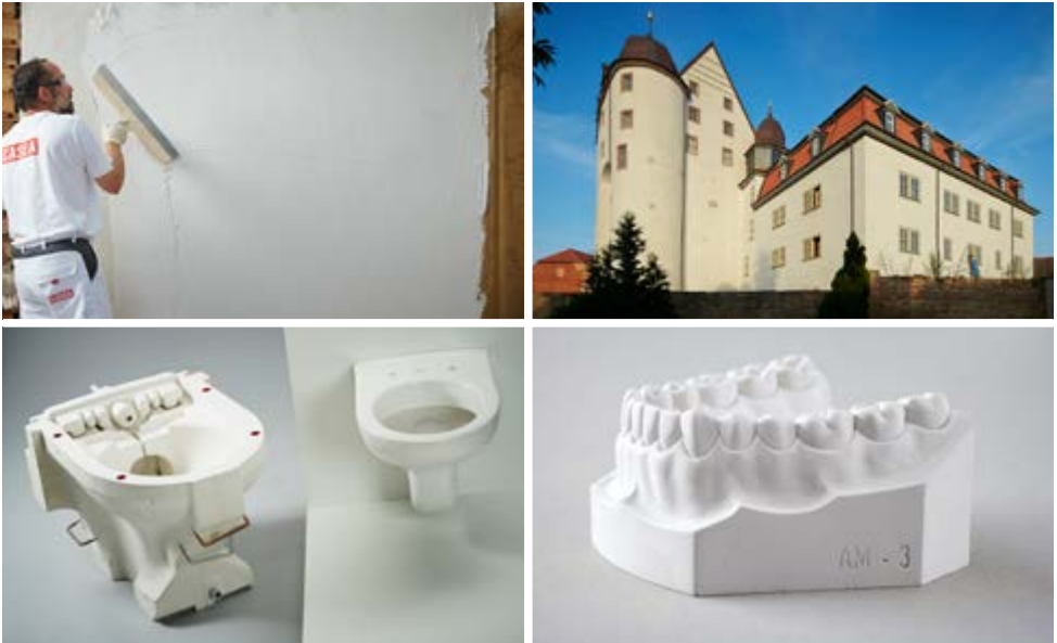
Abbildung 3: Gips-Produkte besitzen ein sehr breites Anwendungsspektrum: a) Gips-Innenputze finden im Wohnungsbau vielfältige Einsatzmöglichkeiten. b) Gips-Außenputze – Die Fassade des Schlosses Heringen bei Nordhausen wurde mit einem historischen Gips-Außenputz wieder hergestellt. c) Formgipse werden in der keramischen Industrie beispielsweise bei der Herstellung von Sanitärkeramik und Porzellan eingesetzt. d) In der Zahnmedizin werden Dentalgipse zur zahntechnischen Modellherstellung verwendet. (Fotos: Casea)
