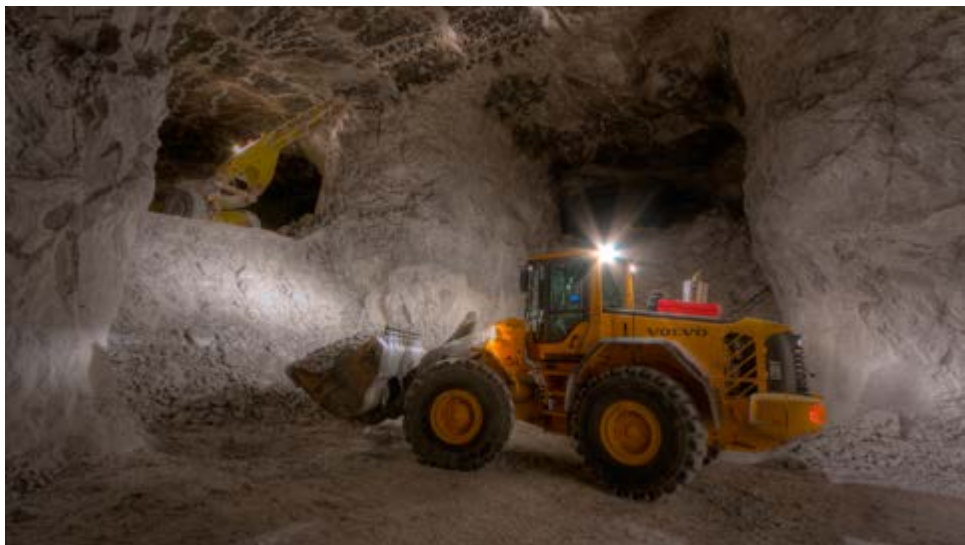
Abbildung 4: Untertagegewinnung im Kammer-Pfeiler-Bau.
