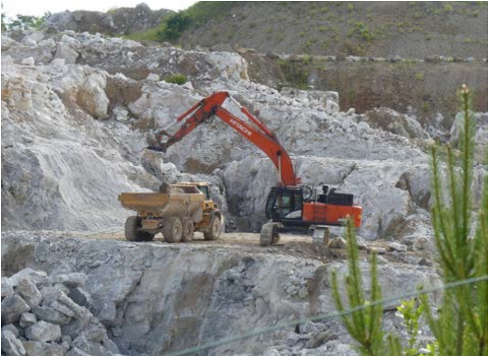
Abbildung 4: Gewinnung von Gipsstein im Tagebau. Am Anfang vieler wirtschaftlicher Wertschöpfungsprozesse steht ein Abbau von Rohstoffen. Gips ist ein Rohstoff mit einem sehr breiten Anwendungsspektrum, das sich nicht nur auf die Baustoffherstellung beschränkt. (Foto: Bernd Wegener)
