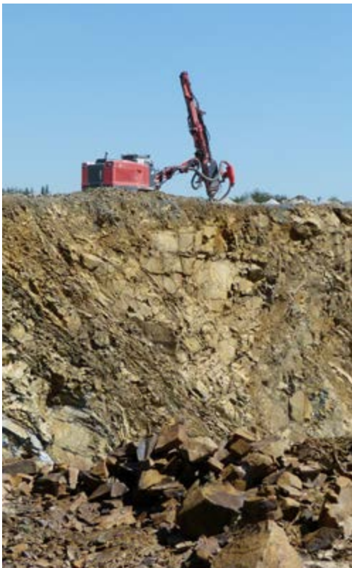
Abbildungen 4, 5 und 6: Technologischer Ablauf der Rohstoffgewinnung: Die Gewinnung des Rohstoffs erfolgt im klassischen Bohr- und Sprengbetrieb. Das gesprengte Haufwerk wird unter Einsatz von Bagger- und SKW-Technik zur Aufbereitungsanlage gefördert, wo es auf den Vorkrecher aufgegeben wird.
