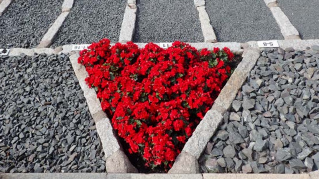
Abbildung 7: Produkte aus gebrochener Grauwacke in verschiedenen Körnungen (5–8, 8–11, 11–16, 16–22 mm) Hartsteinwerk Unterberg der Kemna Bau Andreae GmbH & Co. KG. (Foto: LAGB).
