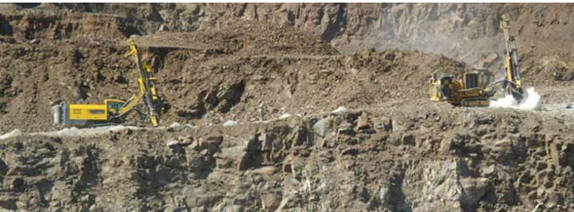
Abbildung 11: Steinbruch Unterberg. Die Gewinnung der Grauwacke erfolgt im Bohr- und Sprengbetrieb. (Foto: K. Stedingk)
