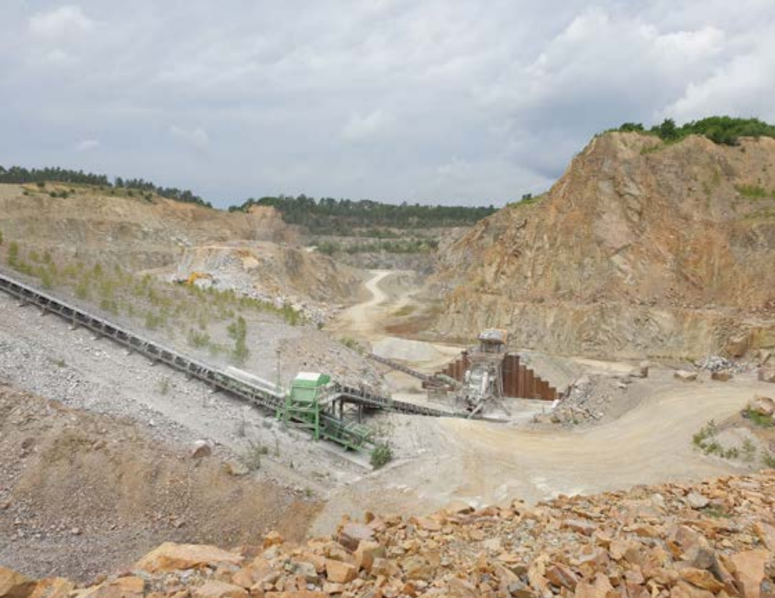
Abbildung 8: Steinbruch Schwarzkollm mit Brecheranlage und Bandtrasse zum Lagerplatz. (Foto: H. Schubert, August 2021)
