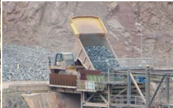
Abbildungen 4, 5 und 6: Technologischer Ablauf der Rohstoffgewinnung: Die Gewinnung des Rohstoffs erfolgt im klassischen Bohr- und Sprengbetrieb. Das gesprengte Haufwerk wird unter Einsatz von Bagger- und SKW-Technik zur Aufbereitungsanlage gefördert, wo es auf den Vorkrecher aufgegeben wird.
